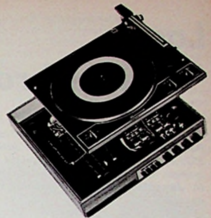
Afb. 22. Inbouw van een complete Sinclair versterker in de voet van een Garrard draaitafel.
